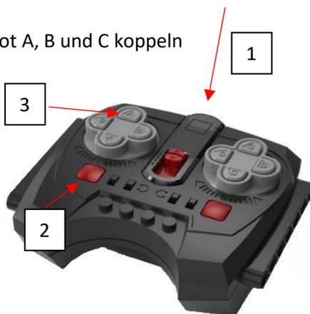
Anleitung Slot A und C koppeln und anschließend den Koppelschalter [L] drücken und mit der Taste A bestätigen.
