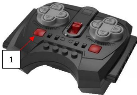
Nach dem Funktionstest aller Motoren einfach Koppelschalter [L] drücken und Slot A und B sind auf der Fernbedienung mit den Tasten A ansteuerbar.
